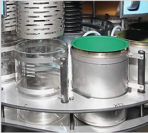
Przestrzeń robocza aparatu Widać teflonowane wnętrza naczyń ciepłarki
