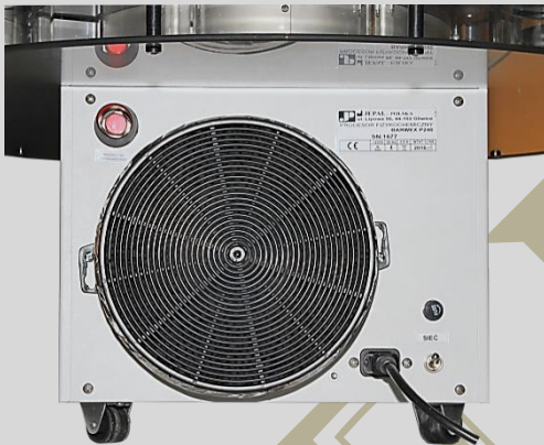
Tył aparatu : przycisk serwisowy (z lewej górnej strony) wyłącznik i kabel sieciowy, tabliczka znamionowa . Pokazano opcje wyciągu z filtrem węglowym lub z króćcem wylotowym , z nasuniętym węzłem odciągowym . Widoczne rolki do obrotu aparatu wokół osi głównej
