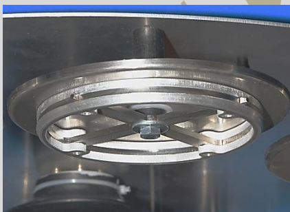
Wieszak koszyka. Widoczne 4-ry kliny mocujące , pokrywa naczynia
