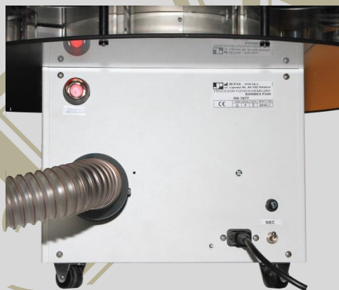
Tył aparatu : przycisk serwisowy (z lewej górnej strony płyty tylnej), wyłącznik i kabel sieciowy, tabliczka znamionowa . Pokazano opcje wyciągu z filtrem węglowym lub z króćcem wylotowym , z nasuniętym wężem odciągowym . Widoczne rolki do obrotu aparatu wokół osi głównej
