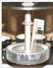
Barwex B80 , B12U : statyw na preparaty , naczynie szklane , płuczka wodą bieżącą
