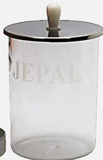
Barwex B80 , B12U : statyw na preparaty , naczynie szklane , płuczka wodą bieżącą
